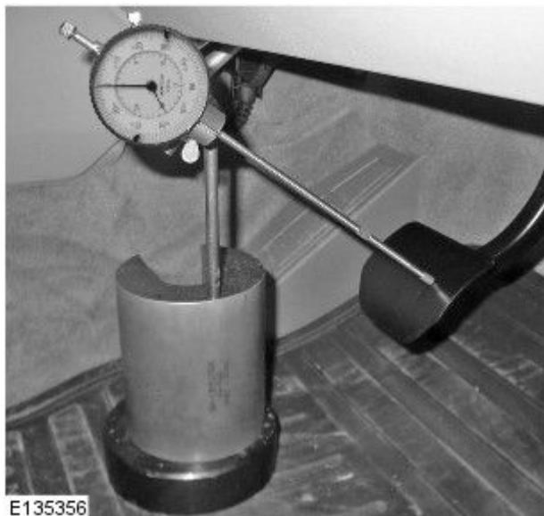
2. 注意: 确保千分尺(DTI) 测量杆与制动踏板的运动方向一致。
